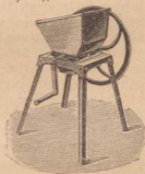
Rübenschneidmaschine von Ph. Mayfarth, Frankfurt a. M.
