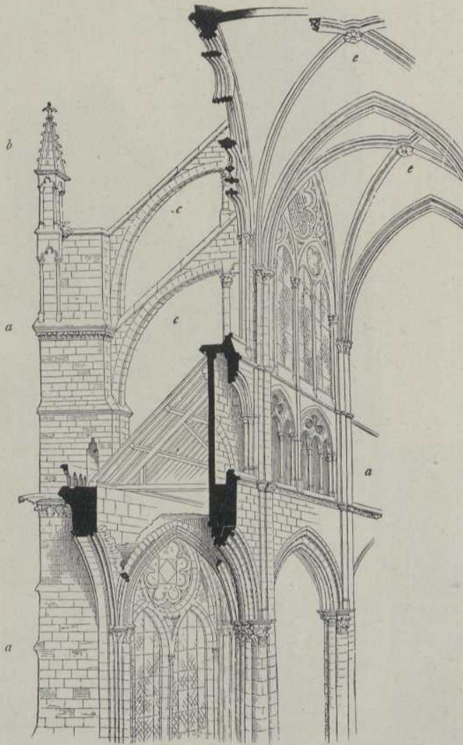
Abb. 34. Gotisches Bausystem (Dom von Amiens).
