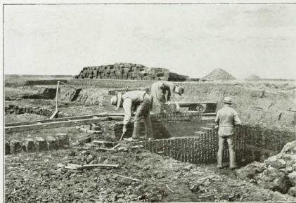
80. Torfstich im Hochmoor bei Bremen. Das Sinken des Wasserstandes ruft im Frühsommer den Moorbauer ins Moor. In mühsamer Arbeit sticht er mit schmalen, scharfgeschliffenem Spaten die verfilzten Schichten der „brennbaren Erde“ ab, häuft sie auf, damit der Wind sie trocknet, und fährt den Brennstoff in Rähnen auf dem Kanal zur Stadt. Aus den obersten Moorschichten wird Torfstreu gewonnen.
