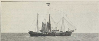
36. Das Feuerschiff „Elbe 2“. Feuerschiffe sind im Unterlaufe großer Ströme fest verankert und haben den Zweck, während der Dunkelheit das Fahrwasser zu bezeichnen. „Elbe 2“ liegt nord-nordöstlich von Neuwark zwischen zwei Sandbänken. Es hat im Großtopp zur Kennzeichnung einen schwarzen Korb und zeigt in der Nacht in einer Höhe von 11 m über Wasser ein weiches, etwa 8 Seemeilen weit sichtbares, unbewegliches Licht.
