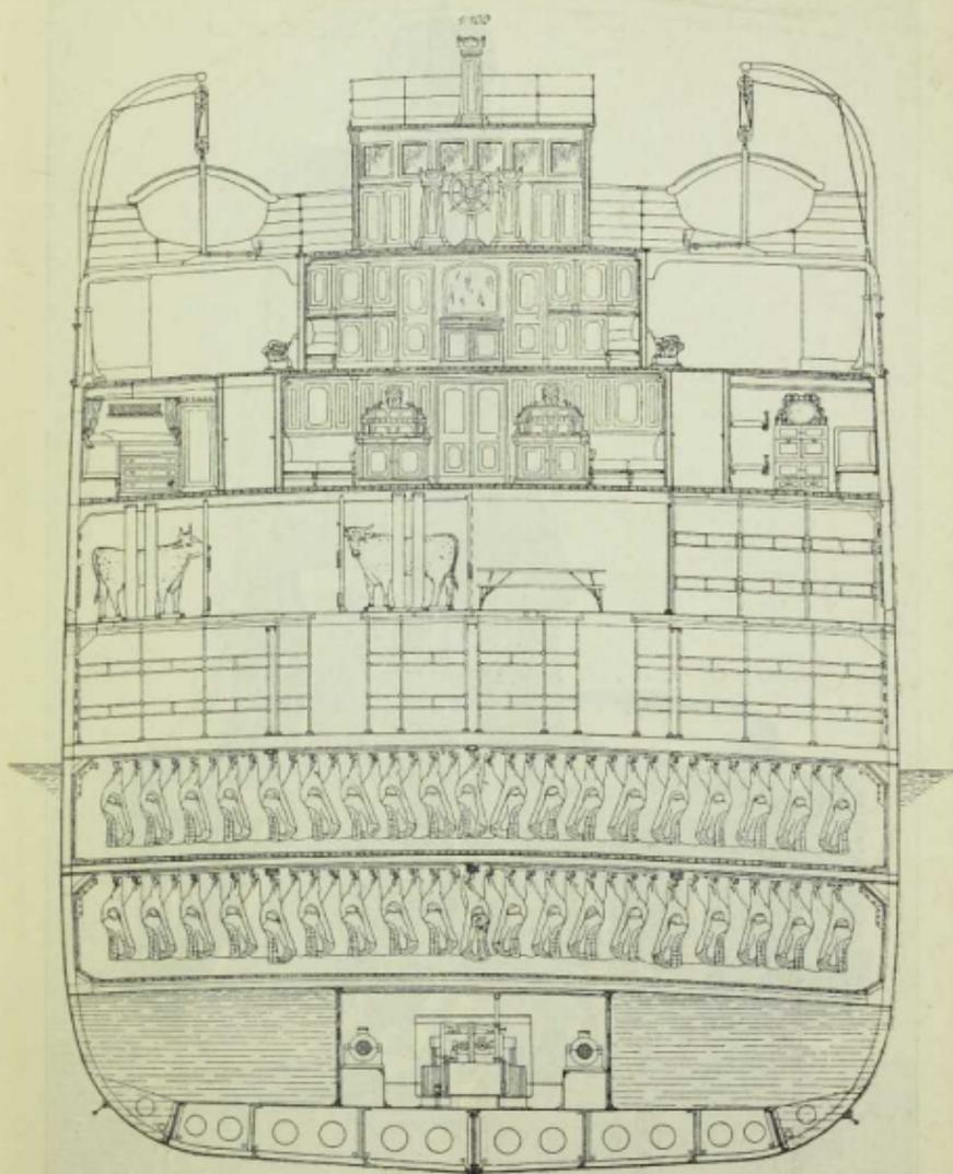
Fig. 10. Querschnitt eines Spezialdampfers zum Transport von Vieh und gefrorenem Fleisch.
