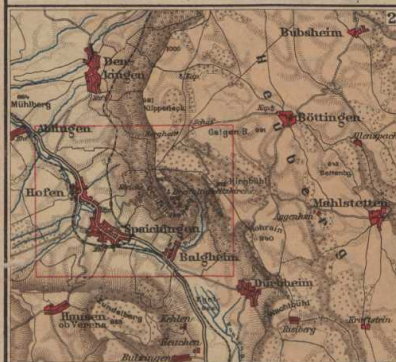
Geländedarstellung durch Schraffen, Höhenkurven und farbige Höhenstufen. Entstehung eines freistehenden Einzelberges durch rückschreitende Erosion Maßstab 1:25.000, Maßstab 1:100.000, Maßstab 1:200.000. W. A. F. 28.
